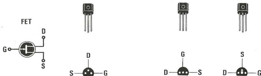
Fig. 3 Se il fet dispone di un corpo plastico a mezzaluna e i terminali sono disposti a triangolo, quasi sempre al centro troveremo il terminale Drain, sulla sinistra il Source e sulla destra il terminale di Gate. Le connessioni sono sempre viste da sotto
